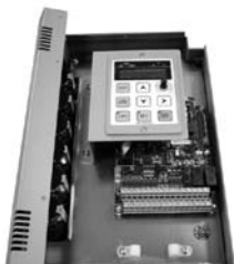
步驟2：完成拆卸面板工作
