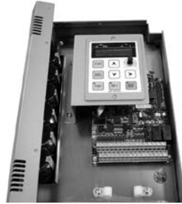
步驟2：完成拆卸面板工作
